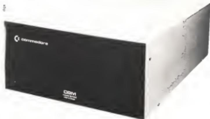
**DISCO RIGIDO CBM 8430** tecnologia WINCHESTER 30MB, interfaccia IEEE-488 con possibilità di collegare quattro unità centrali Commodore. Il sistema operativo del disco è completamente compatibile con il DOS 2.5 della unità a floppy disk CBM 8050 e quindi i programmi possono essere trasferiti e resti attivi sulla nuova unità assolutamente senza modifiche.
